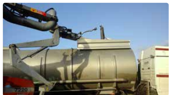
Monteret kamera til overvågning af gylleopfyldning i tanktrailerens.
